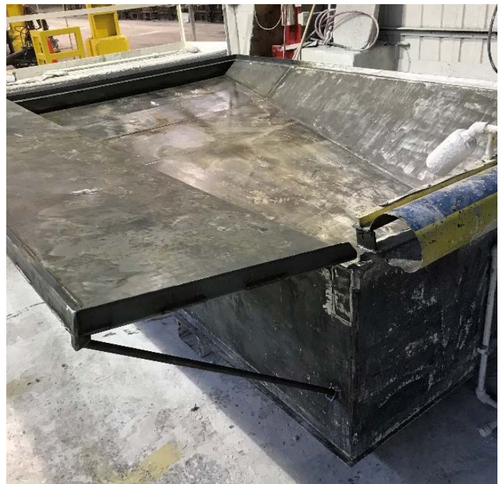
Extensiones del tanque de capa fluida Corerroom diseñadas por el pasante Tyler Haygood
