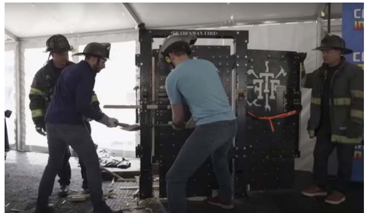
Jacob Melvin y Jacob Poore probando la Barra Halligan de Herron usando una Prueba de Puerta de Bombero.
