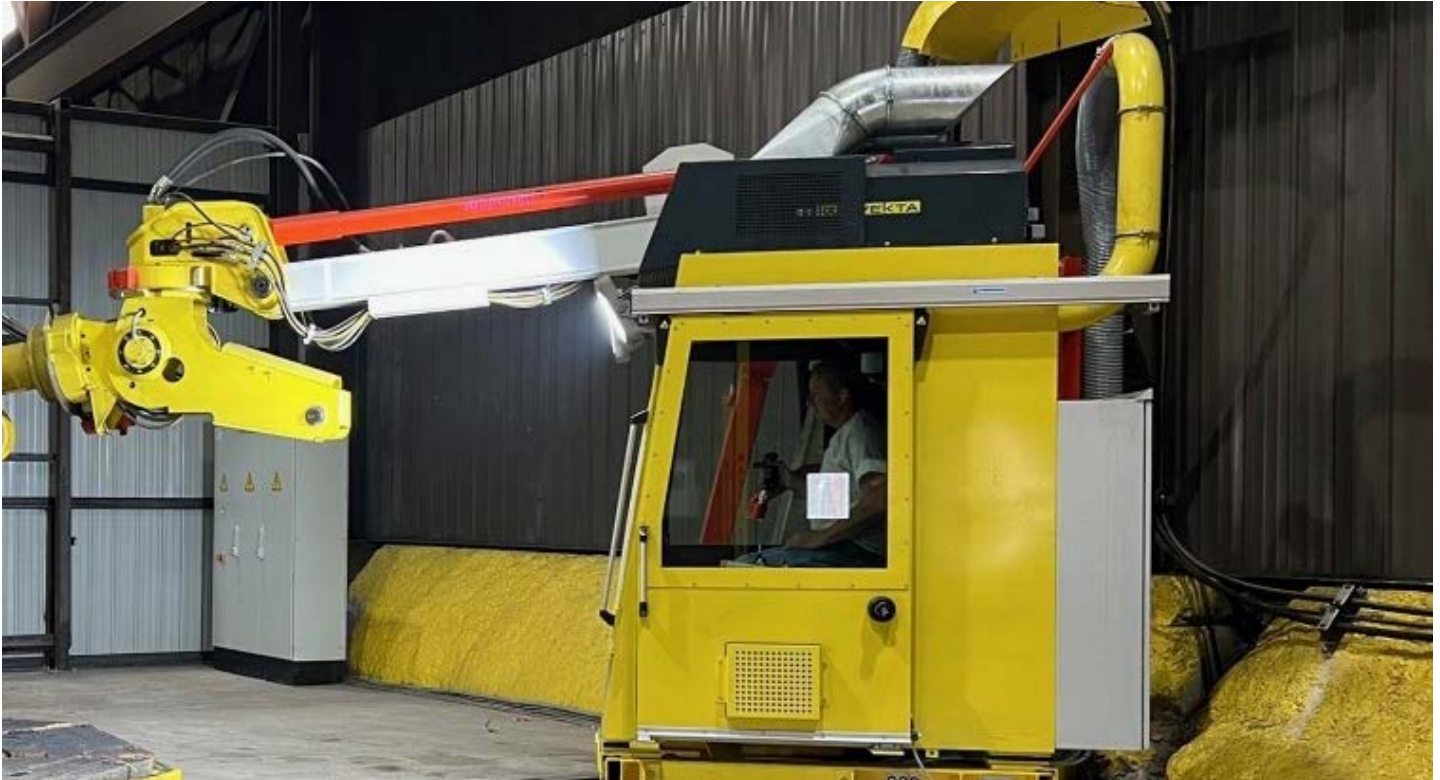
Andromat, gran rectificadora controlada desde cabina en Planta 2
