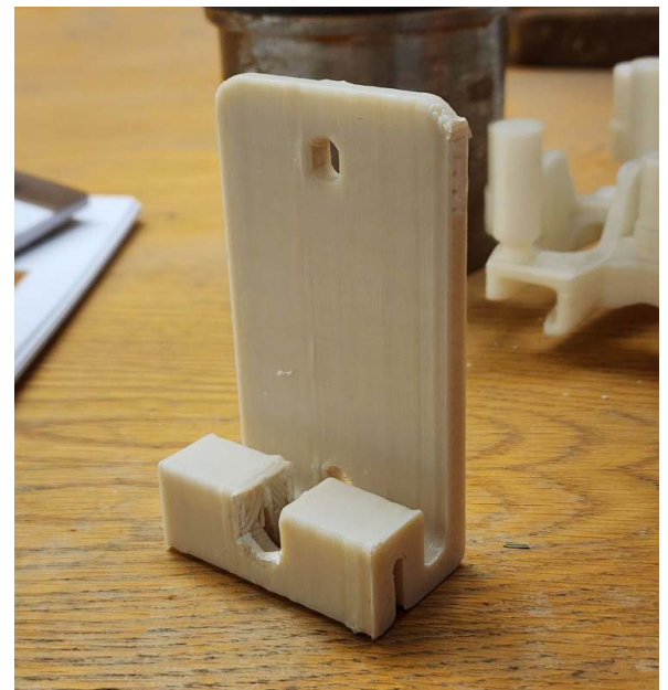
La impresora 3D del Pattern Shop sigue disponible para prototipos. Nathan Leonard ha desarrollado varios diseños para usarse en la celda de quemado robótico (robotic burning cell). A continuación se puede ver un soporte para cortina de luz (light curtain mount) que Jacob imprimió para el Cleaning Room.
