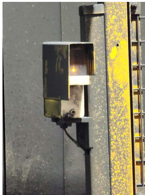
La impresora 3D del Pattern Shop sigue disponible para prototipos. Nathan Leonard ha desarrollado varios diseños para usarse en la celda de quemado robótico (robotic burning cell). A continuación se puede ver un soporte para cortina de luz (light curtain mount) que Jacob imprimió para el Cleaning Room.
